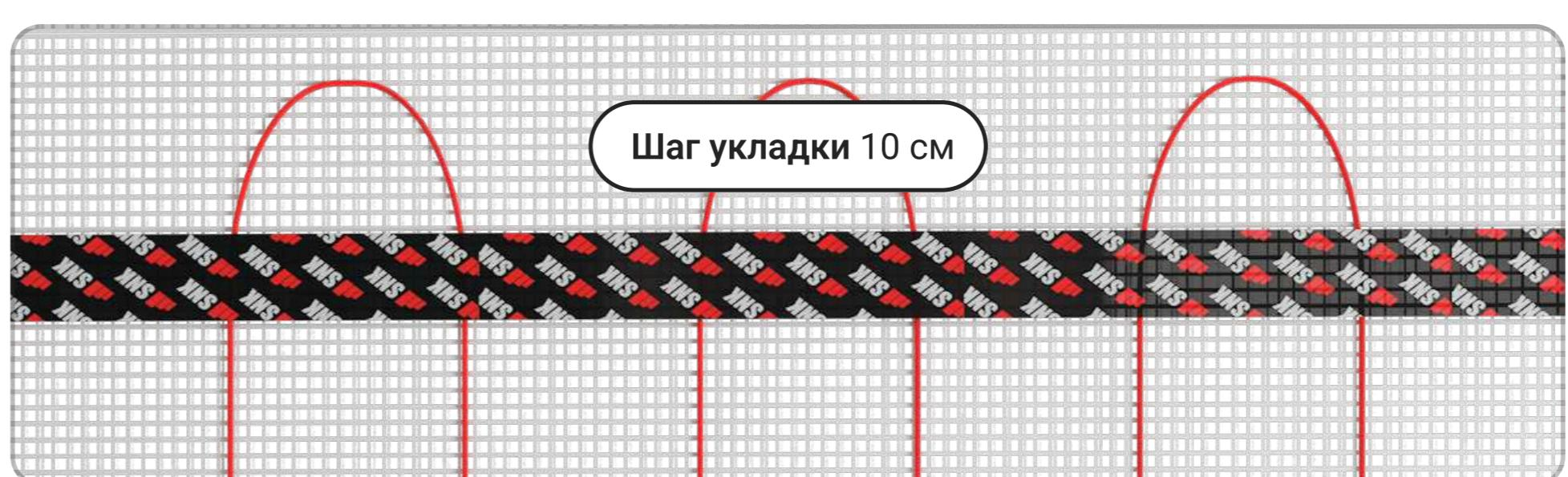
**Благодаря шагу укладки кабеля в 10 см**
