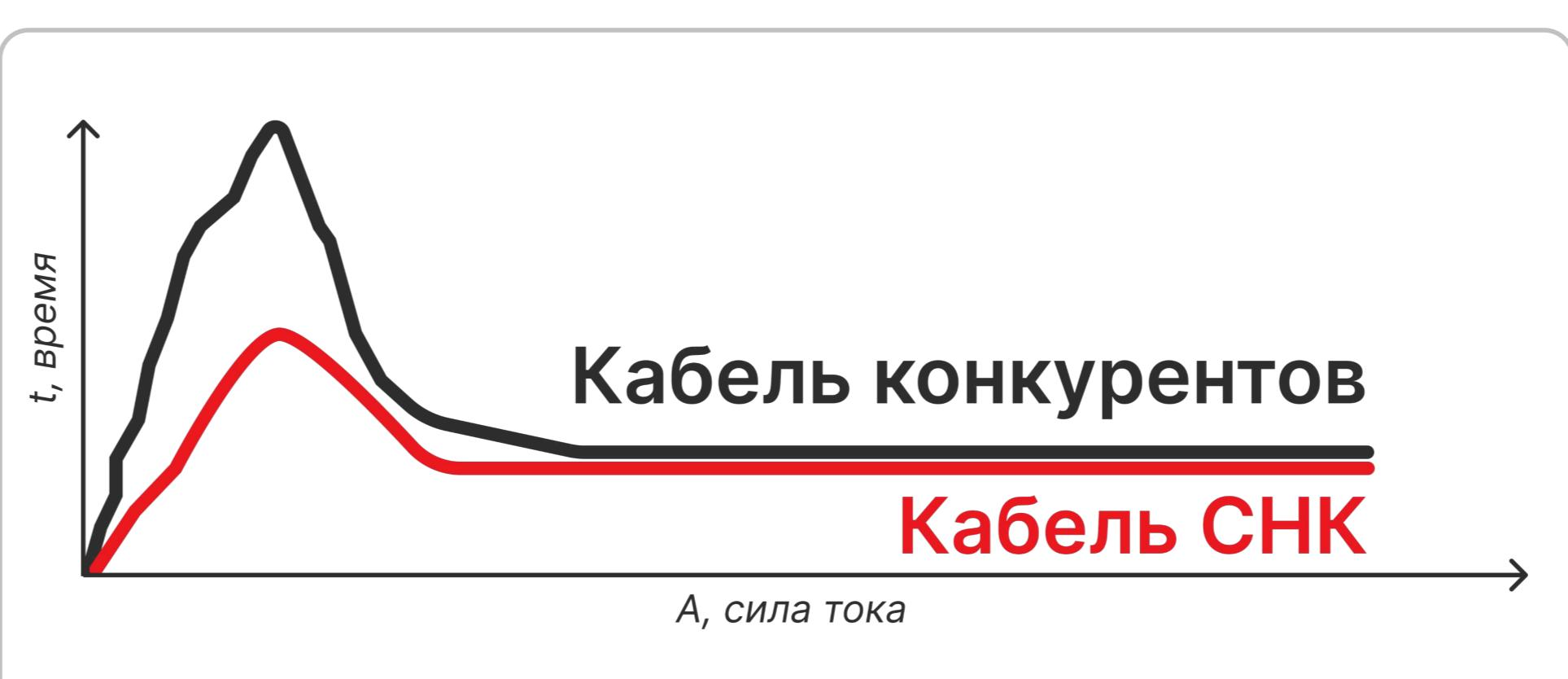
**Уменьшенные до 3 раз пусковые токи** позволяют использовать кабель на объектах с небольшой подключенной мощностью
